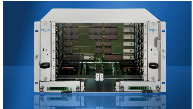
Vorderansicht des hochverfügbaren Systems mit Blick auf die Backplane
