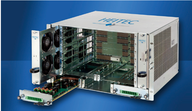
Übersicht des Gesamtsystems mit Blick auf eine Lüftereinheit und Lüftersteuerung
