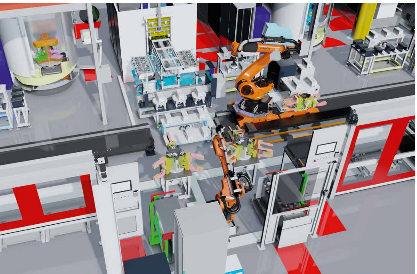
Die virtuelle Inbetriebnahme am digitalen Modell ermöglichte dem Kunden eine deutlich frühere Auslieferung der Anlage.
